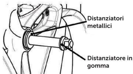
PASSO 10: Installare le ruote nella carrozzina.
