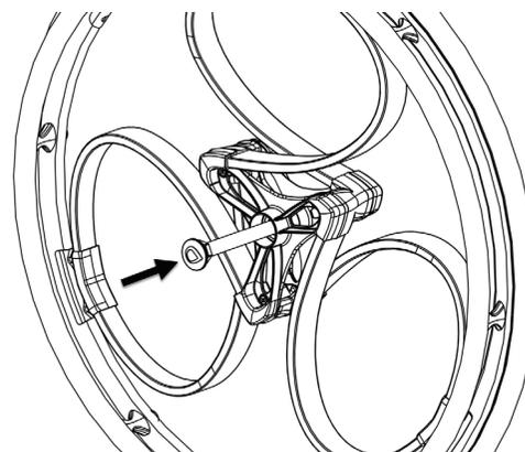
PASSO 6. Installare il perno (con la ruota installata) nell'alloggiamento della carrozzina, un lato per volta.
